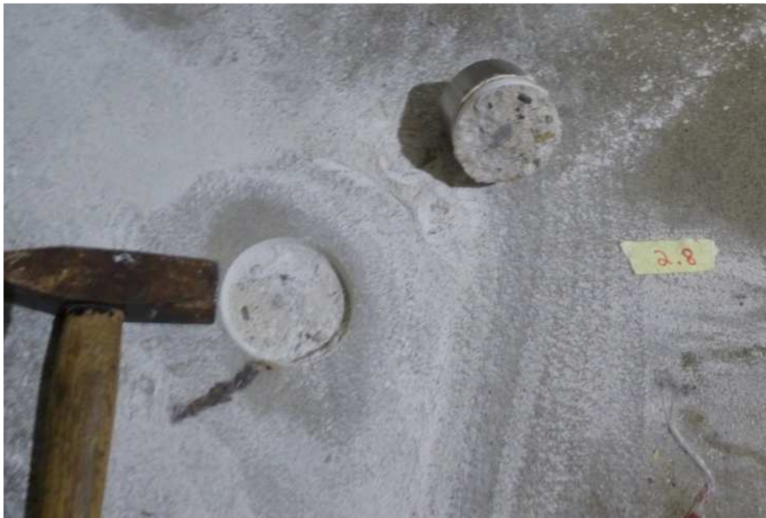
Bild 15: Untersuchungspunkt 2.8 nach Messung (Stempel mit Hammer abgeschlagen)
